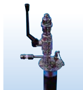
モービルヘッド(オプション) 1 トランスファー用ポートφ10mm 2 トランスファー用ポートφ12mm 3 レベルセンサー用ポートφ2.5mm 4 安全弁0.5bar
